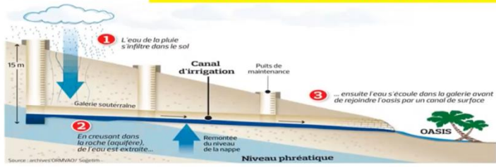
Schéma simplifié d'une « khettara »
