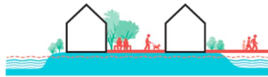
Construction sur socle remblais
