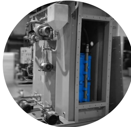
Traitement de l'eau par ultrafiltration
